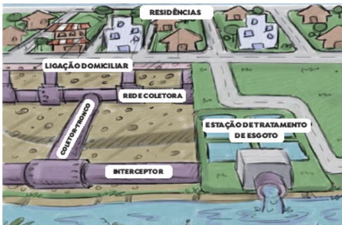
Figura 2: Elementos do Sistema de Convencional de Coleta de Esgoto
